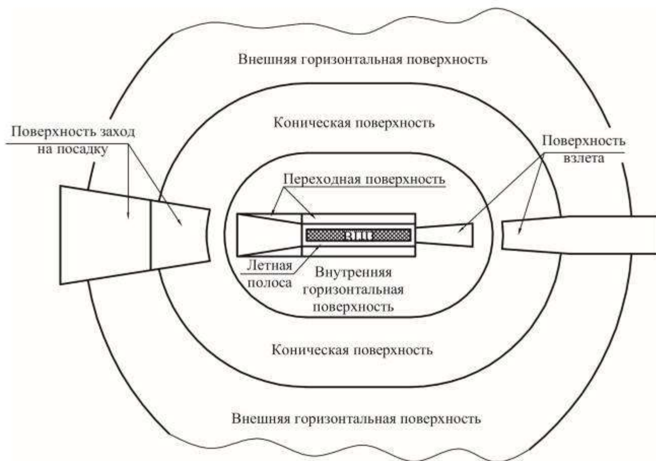
Рисунок 1. Поверхности ограничения препятствий
