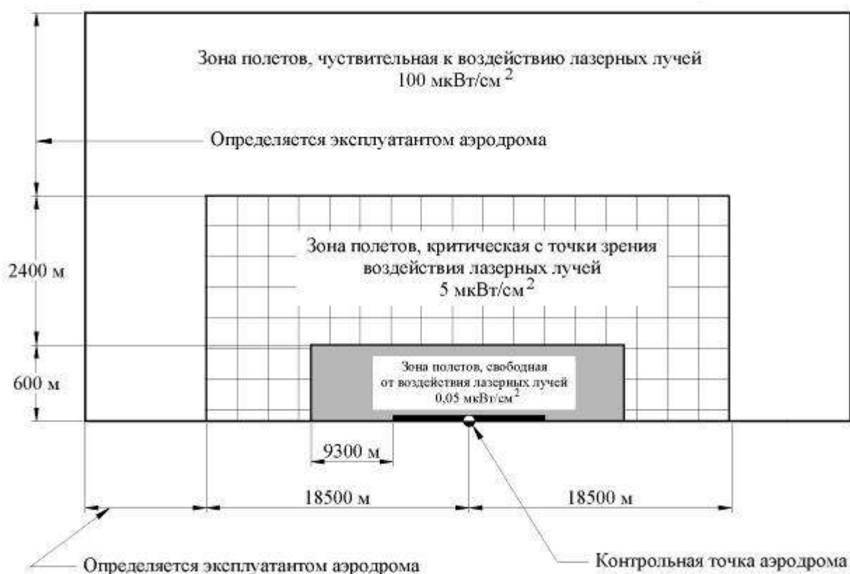
Рисунок 3. Защитные зоны с указанием максимальных уровней излучения для видимых лазерных лучей
