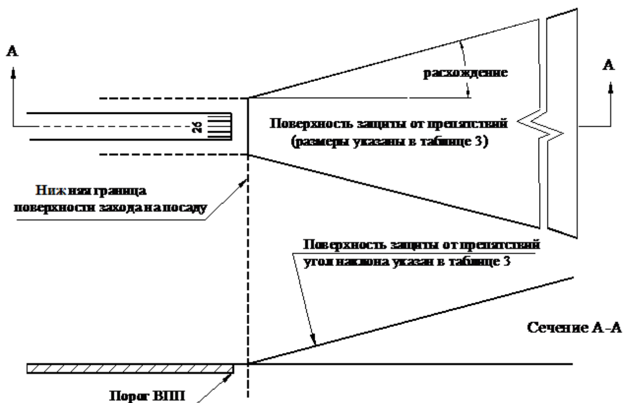
Рисунок 5. Поверхность защиты от препятствий систем визуальной индикации глиссады
