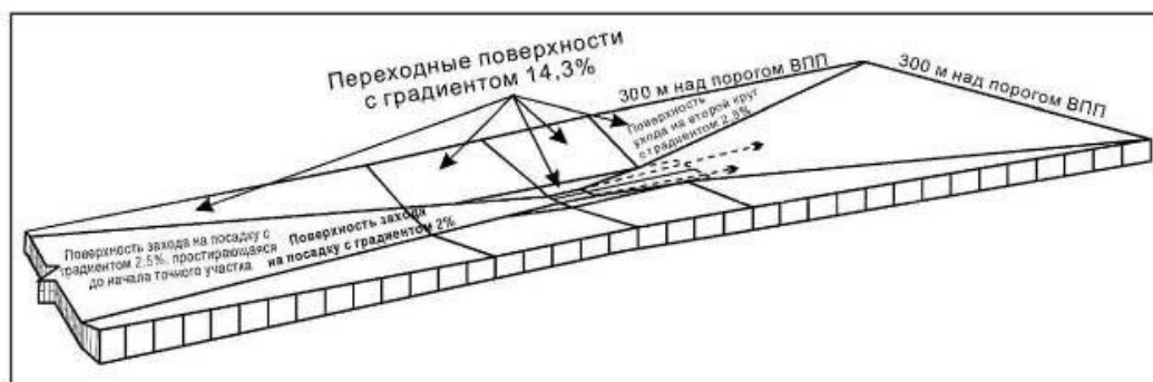
Рисунок II-1-3-7 - Иллюстрация основных поверхностей ILS, описанных в п. 1.3.4.7.2 главы 1.3
