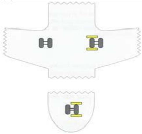
Примечание: применяется установка упорных колодок как на внутреннее, так и на наружное колесо стойки шасси
