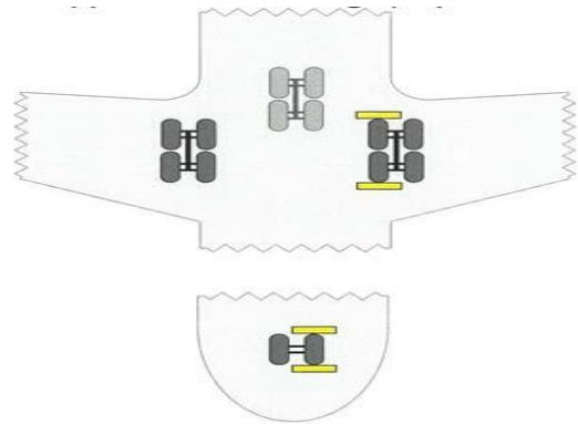
Примечание: применяется установка упорных колодок как на внутреннее, так и на наружное колесо стойки шасси
