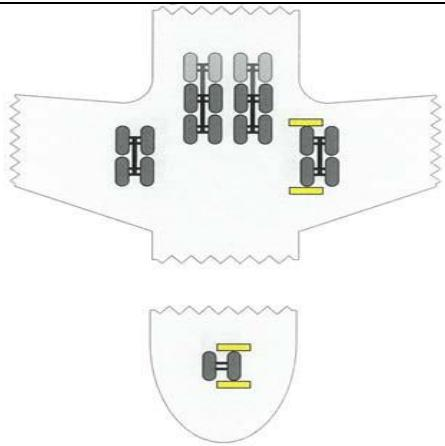
Примечание: применяется установка упорных колодок как на внутреннее, так и на наружное колесо стойки шасси
