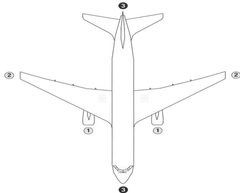
Расстановка конусов безопасности для ВС с двумя реактивными двигателями, установленными на фюзеляже
