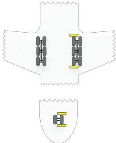
Примечание: применяется установка упорных колодок как на внутреннее, так и на наружное колесо стойки шасси
