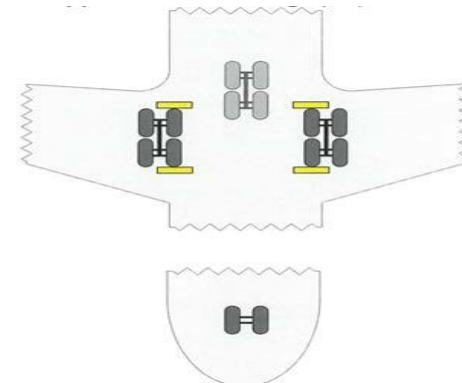
Примечание: применяется установка упорных колодок как на внутреннее, так и на наружное колесо стойки шасси
