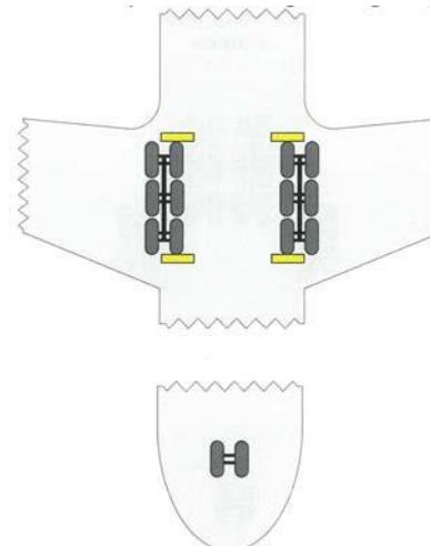
Примечание: применяется установка упорных колодок как на внутреннее, так и на наружное колесо стойки шасси
